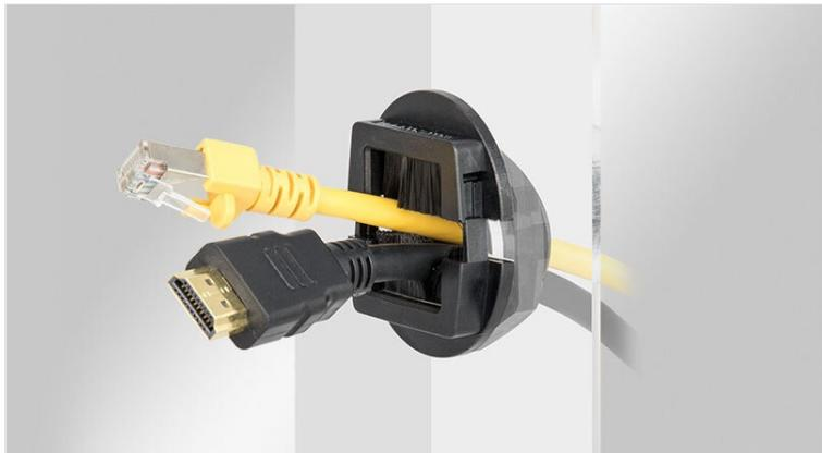
icotek vous propose une brosse passe-câbles ronde en M32 et M50 qui se fixe par encliquetage (épaisseur de paroi de 1 à 2.5 mm) ou avec un contre-écrou. Le presse-étoupes à brosse divisible KEL-BES-S a été développé pour le passage de câbles avec et sans connecteurs dans des armoires, des serveurs, des coffrets électriques ...
